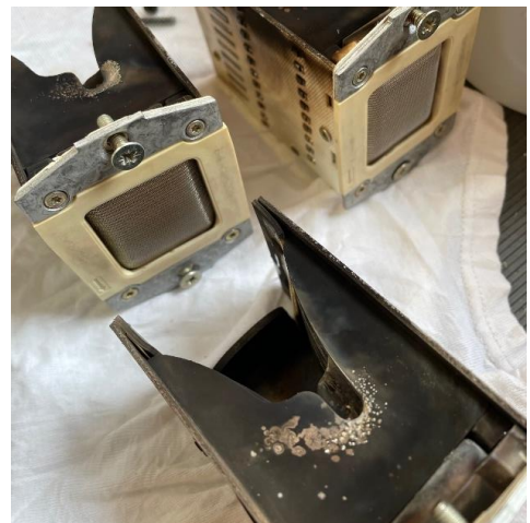
Generatorschalter mit abgebrannten Kontakten
